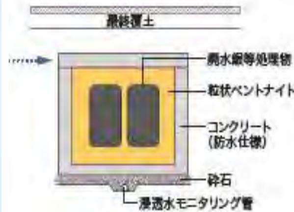
上記の方法で得られた廃水銀等処理物は、環境庁告示13号溶出試験の基準値（水銀0.005mg/L以下）、及びヘッドスペース分析（温度条件：10～70°C）において水銀0.001mg/m<sup>3</sup>未満を達成できることが確認されています。
