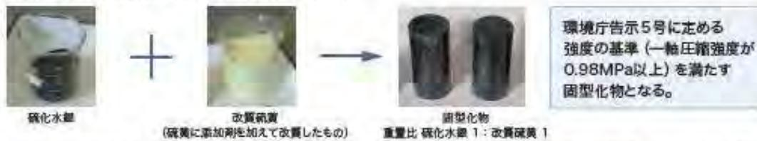
上記の方法で得られた廃水銀等処理物は、環境庁告示13号溶出試験の基準値（水銀0.005mg/L以下）、及びヘッドスペース分析（温度条件：10～70°C）において水銀0.001mg/m<sup>3</sup>未満を達成できることが確認されています。
