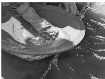
写真4 鉱石と水銀の混合作業
