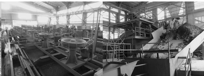
写真15 浮遊選鉱工程
