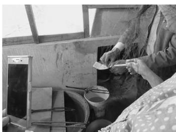
写真7 水銀アマルガムの加熱作業
