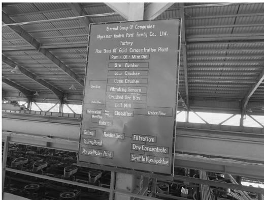
写真13 選鉱作業の流れ図を示す看板
