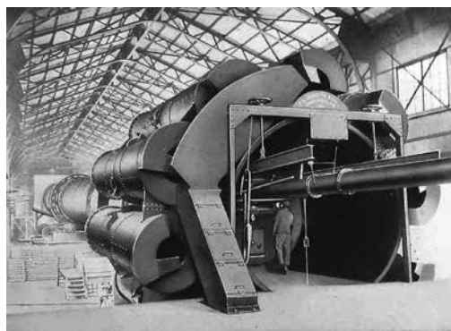
図3 八代工場で使用されたロータリーキルン （1936年 中村倉大実習報告書より）
